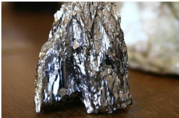
Minério columbita-tantalita, utilizado na produção de ligas metálicas de alta resistência, especialmente em componentes para a indústria aeroespacial e em supercondutores.
