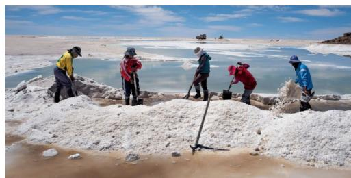
Este método consiste no bombeamento da salmoura para lagoas rasas de evaporação pelo sol, ao ar livre, por um período de um a dois anos, cristalizando determinados sais, como cloreto de sódio, potássio e magnésio, para finalmente ser obtido o carbonato ou cloreto de lítio. Quando se atinge uma concentração ótima de lítio, o produto é bombeado para uma planta de tratamento, onde espécies indesejadas que não precipitaram anteriormente são removidas. O nome desta técnica de separação é
